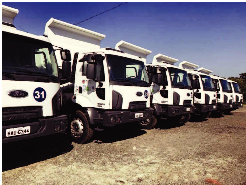
**Figura 8 - Caminhão basculante 6x4.**
